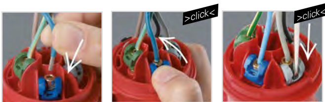
1) Insert wire 2) Close terminal 3) Reopen terminal
